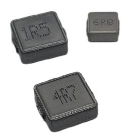
一体成型电感 (模压电感)包括座体和绕组本体,全封闭结构磁屏蔽效果好,可有效降低电磁干扰,同尺寸直流阻抗最低,其一体成型结构可避免发生噪音,应用频率可达 5MHZ,适用于回流焊 SMT工艺。
