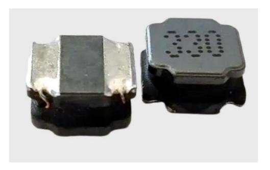
磁胶电感采用磁性胶水涂敷结构,极大减小蜂鸣声音,直接在铁氧体磁芯,上金属化电极,抗跌落冲击强,经久耐用,闭合磁路结构设计,漏磁少,抗 EMI 能力强,小体积,低侧面,节省空间,良好的可焊性和高耐热性,适合大电流。
